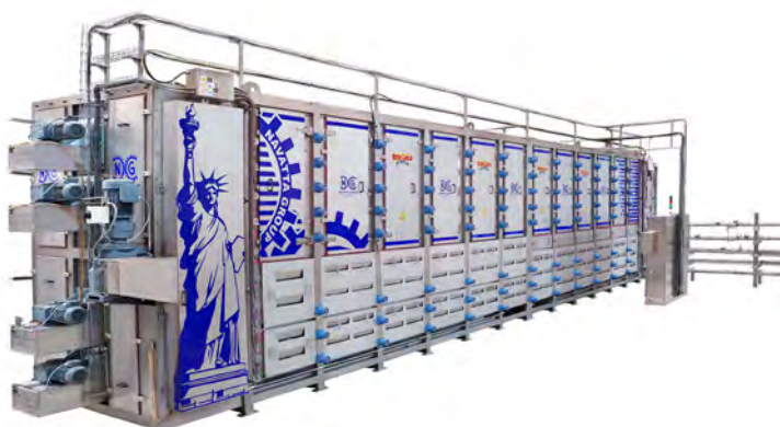
Sterilizzatore rotativo per lattine di ortaggi, pomodori e prodotti a base di frutta con pezzi nel liquido di conservazione.
