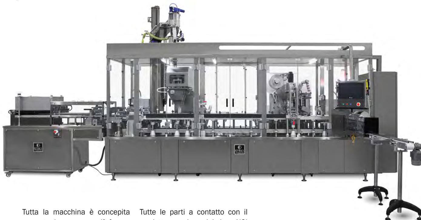
Tutta la macchina è concepita per poter lavorare con più formati sia per prodotti liquidi, polveri o caffè: grazie all'utilizzo di godets per il trasferimento delle capsule e le stazioni di riempimento, inserimento filt o (ove richiesto), trancia e salda top lid, tipo "docking station" facilmente e completamente estraibili, consentono di ottenere un'eccellente pulizia, e soprattutto un rapido cambio formato, effettuato in tempi minimi e senza utilizzo di utensili.
