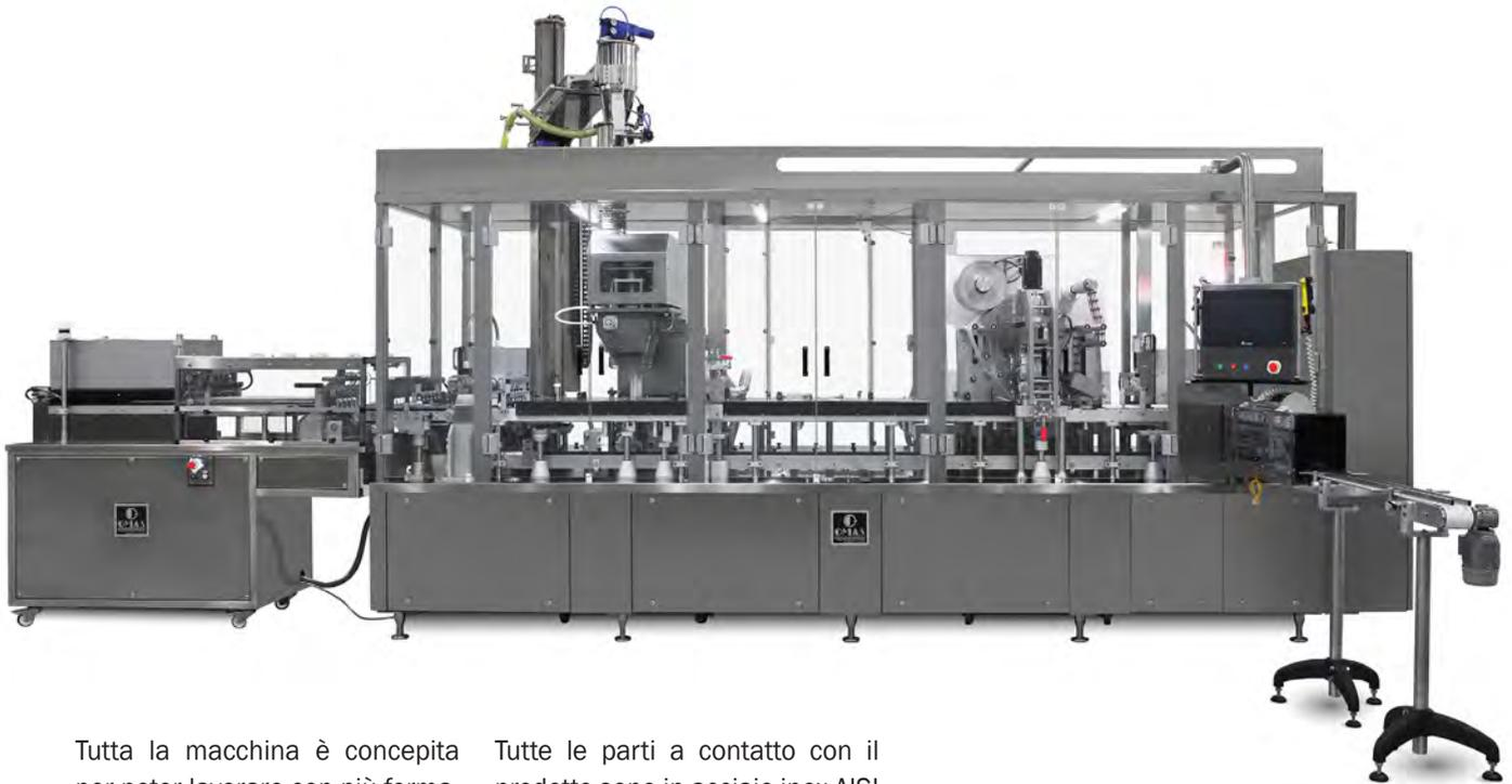
Tutta la macchina è concepita per poter lavorare con più formati sia per prodotti liquidi, polveri o caffè: grazie all'utilizzo di godets per il trasferimento delle capsule e le stazioni di riempimento, inserimento filtro (ove richiesto), trancia e salda top lid, tipo "docking station" facilmente e completamente estraibili, consentono di ottenere un'eccellente pulizia, e soprattutto un rapido cambio formato, effettuato in tempi minimi e senza utilizzo di utensili.
