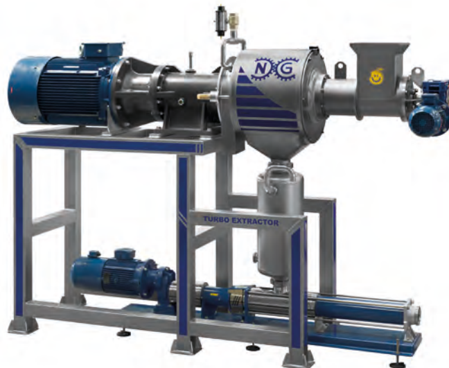
Turbopressa per la spremitura dei cascami di pomodoro con sistema di recupero succo e rilancio in linea
