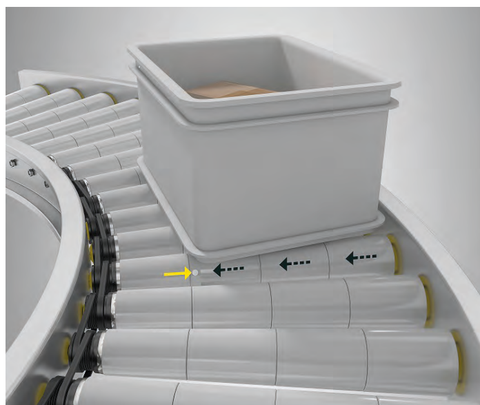
Gli innovativi elementi conici di Interroll offrono un fissaggio ottimizzato nei trasportatori a rulliera curva
