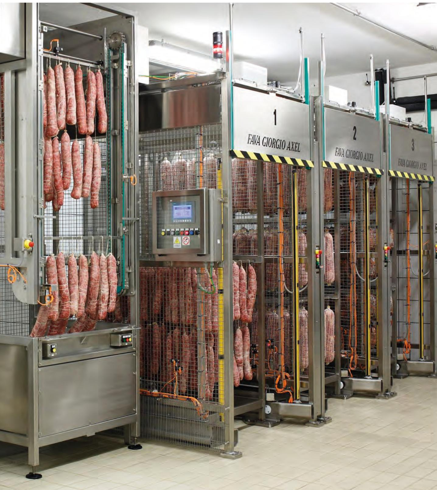
a vantaggio di una più semplice sanificazione ambientale; limitate oscillazioni che riducono i contatti tra i prodotti e le forche di sollevamento e introduzione; dimensionamenti generosi che assicurano una lunghissima vita dei componenti, con costi di manutenzione bassissimi, addirittura trascurabili.
