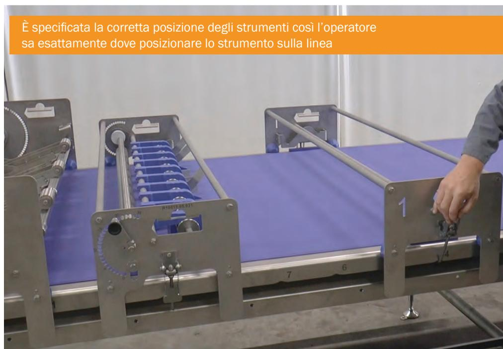
È specificata la corretta posizione degli strumenti così l'operatore sa esattamente dove posizionare lo strumento sulla linea
