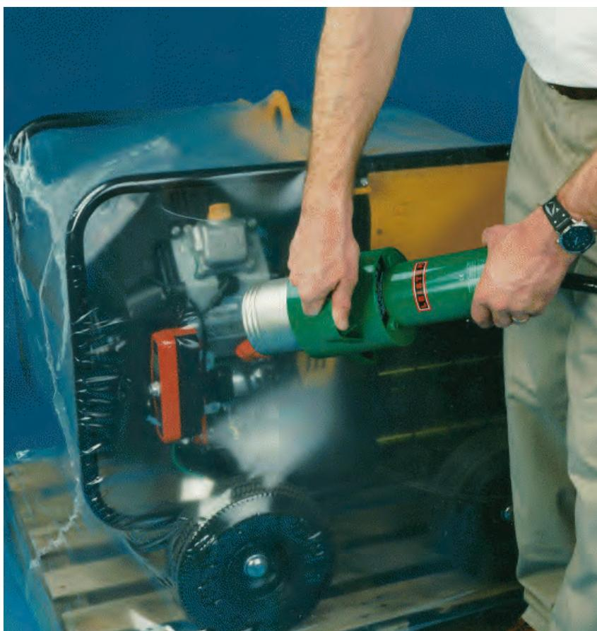
gli apparecchi manuali Leister, unisce una pratica impugnatura a un design compatto (misura solo 390 x 132 x 215 mm) che ne rende agevole l'utilizzo anche in spazi ristretti; un piedino d'appoggio integrato nella struttura dell'apparecchio facilita ulteriormente l'attività dell'operatore. Grazie alla sua potenza, FORTE S3 può erogare un possente getto di aria calda che arriva anche a temperature di 650°C.
