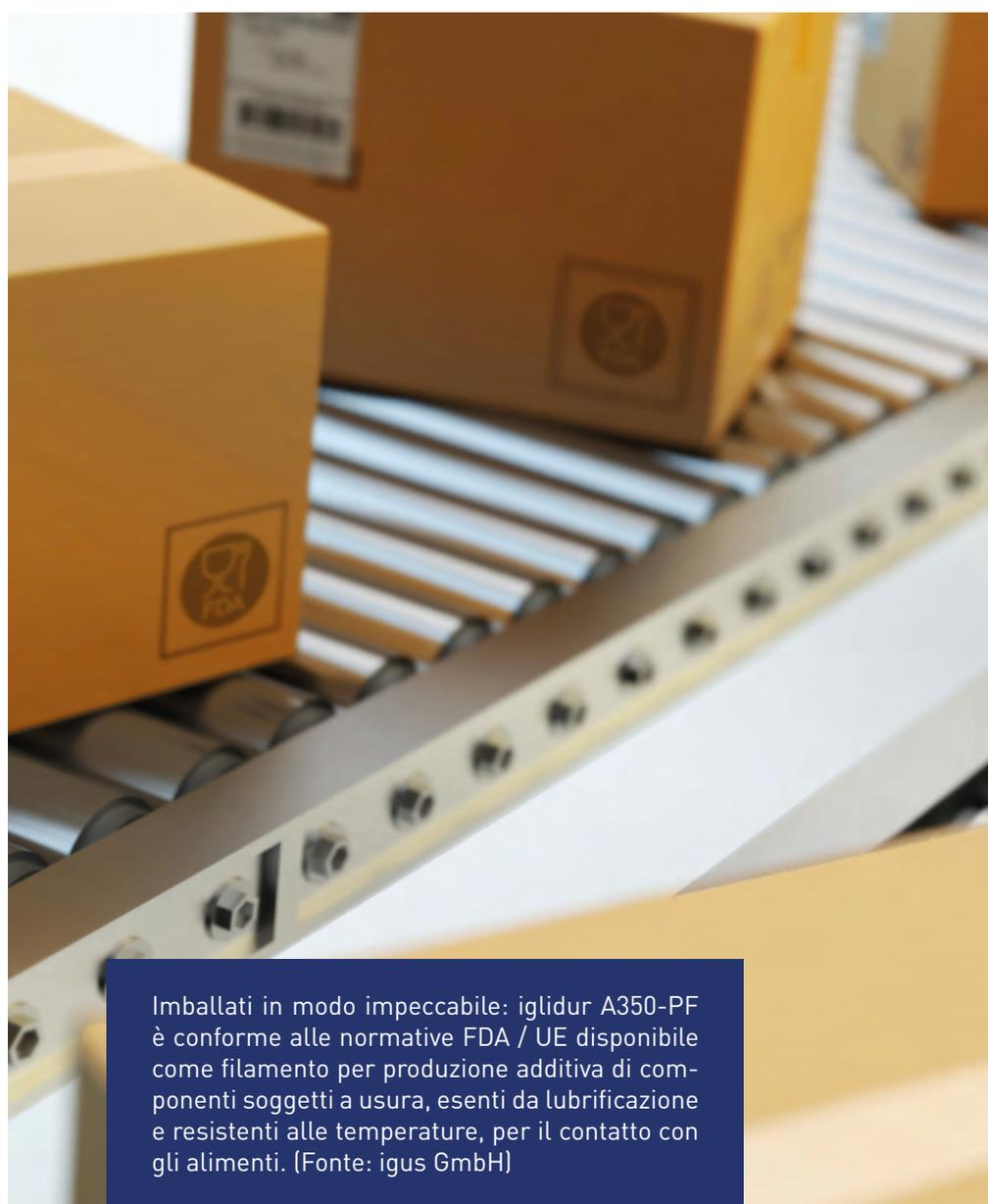
Imballati in modo impeccabile: iglidur A350-PF è conforme alle normative FDA / UE disponibile come filamento per produzione additiva di componenti soggetti a usura, esenti da lubrificazione e resistenti alle temperature, per il contatto con gli alimenti. (Fonte: igus GmbH)
