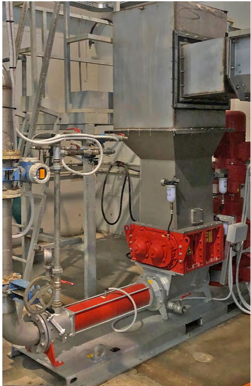
richiede un sistema di aspirazione facile da regolare, per evitare improduttivi periodi di transizione tra un ciclo e l'altro. È anche importante la possibilità di invertire rapidamente il flusso, così da permettere il controlavaggio delle membrane. Sono, come già visto, le caratteristiche tipiche di una pompa volumetrica.
