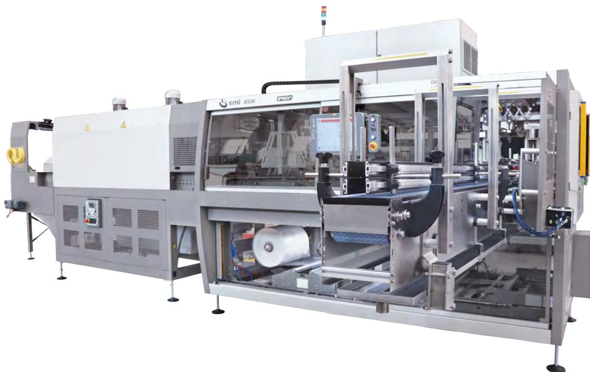
2xn, 3xn, ecc.); questa sezione è caratterizzata da un dosatore, cioè un sistema a doppia cinghia, che, attraverso una camma elettronica, separa i prodotti in base al formato da lavorare. Successivamente, grazie all'introduttore di tipo rotativo, i prodotti sfusi sono traslati dal trasportatore monofilare al nastro trasportatore multi-via in ingresso macchina;
