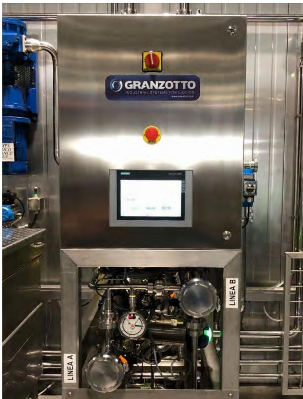
una per olio di oliva convenzionale e una per olio biologico, dotate entrambe di sistema "pig", tutte le operazioni vengono eseguite in modo automatico garantendo la massima efficienza ed efficacia.
