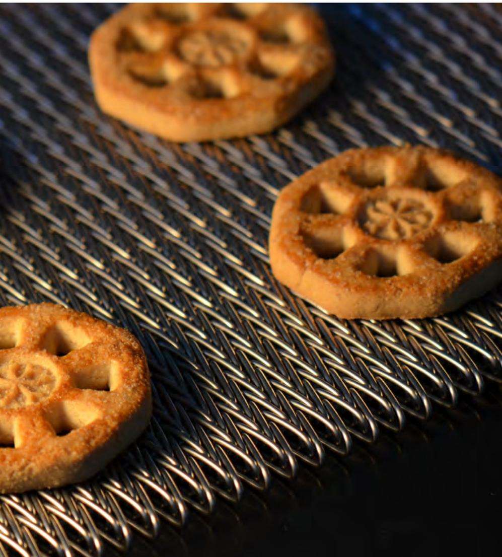
Il nastro VICO-TU è costituito da spirali con passo avvicinato, a torsione alternata (una destra e una sinistra) e collegate mediante traversini diritti. Questo nastro può essere utilizzato anche in tunnel continui per l'imballaggio.
