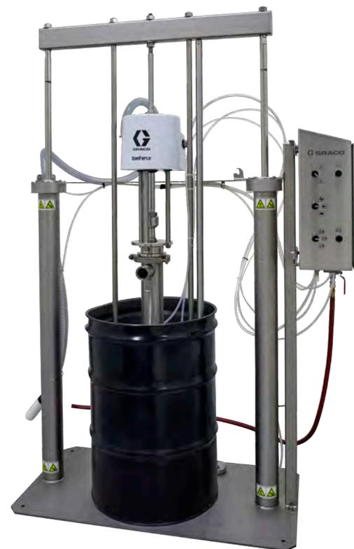
pannello di controllo touch. Tra le sue capacità vi sono: sequenza di scarico completamente automatizzata; archiviazione di ricette/ingredienti; caratteristiche di ricircolo della pompa; comandi batch in uscita; e spostamento ram.
