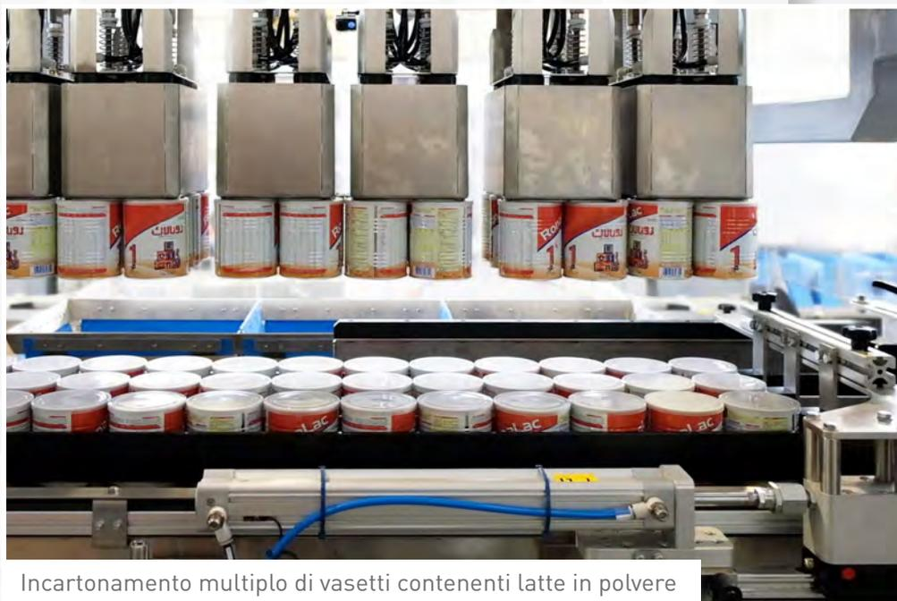
Incartonamento multiplo di vasetti contenenti latte in polvere
