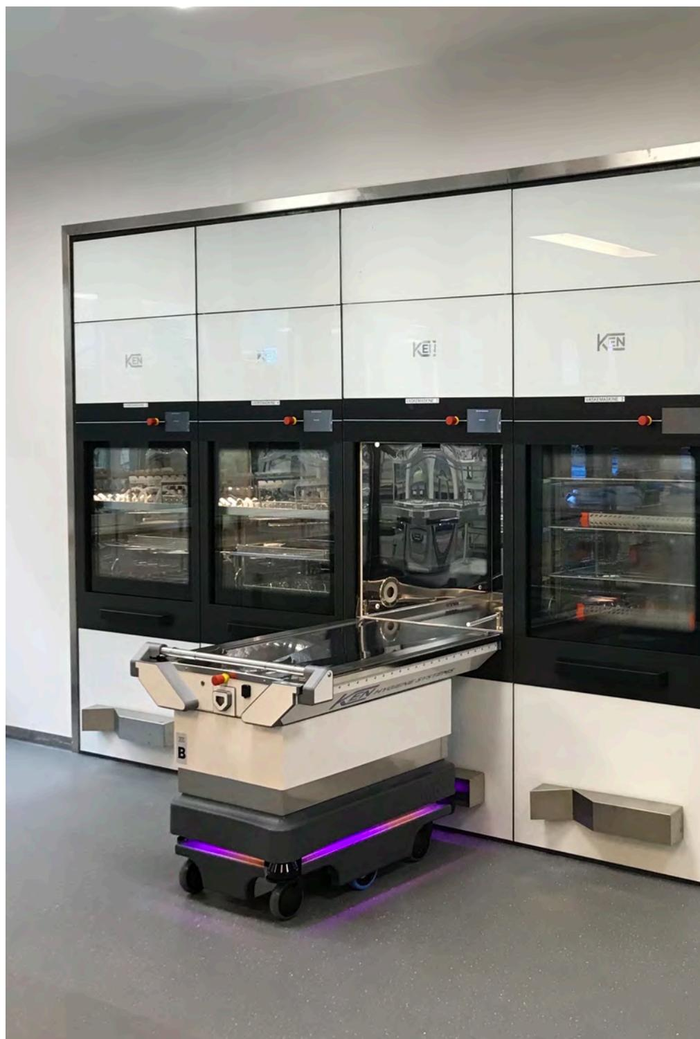
lavaggio e, una volta che gli strumenti sono stati puliti e disinfettati, un altro robot arriva sul lato "pulito", svuota l'autoclave e completa l'operazione trasportando il cestello al reparto imballaggio. I robot inoltre, ritornano automaticamente alla loro stazione di ricarica per restare in piena efficienza.
