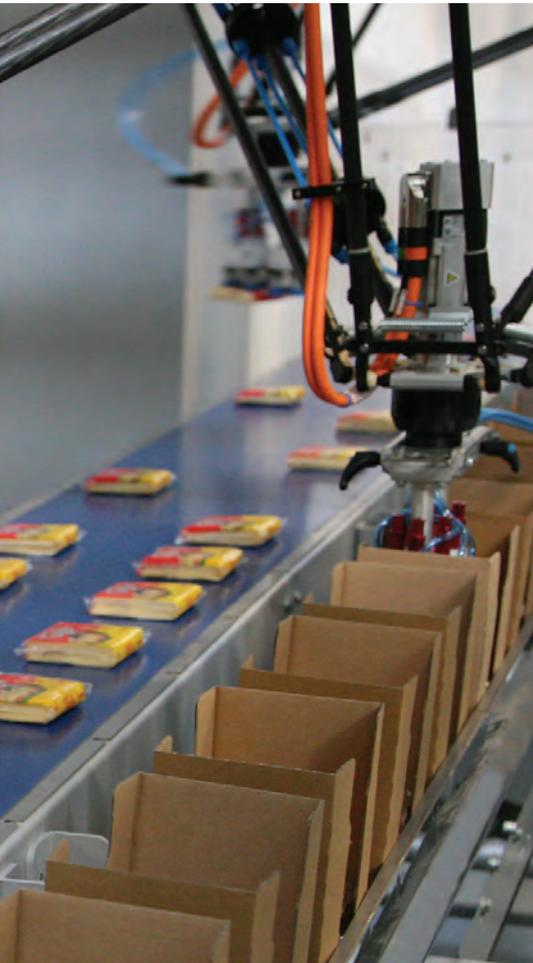
za per la flessibilità. Dato che ogni ventosa è abbinata ad un singolo generatore di vuoto, possiamo scegliere di far funzionare solo alcune delle quattro ventose di ciascun organo di presa.
