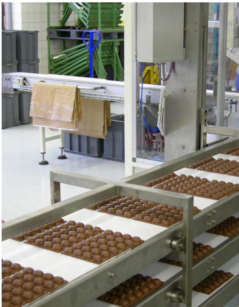
mata dalla macchina a valle, i prodotti vengono passati dalla linea principale al nastro lanciatore tramite la testata oscillante: il lanciatore passerà a sua volta i prodotti al nastro di estrazione, capace di traslare lateralmente tramite una slitta a movimentazione brushless per ricevere al meglio i prodotti in arrivo.
