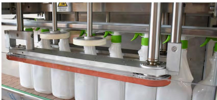
L'impianto ha un distributore di capsule, con canalina di discesa regolabile per diversi formati e dispositivo di controllo presenza capsule.
