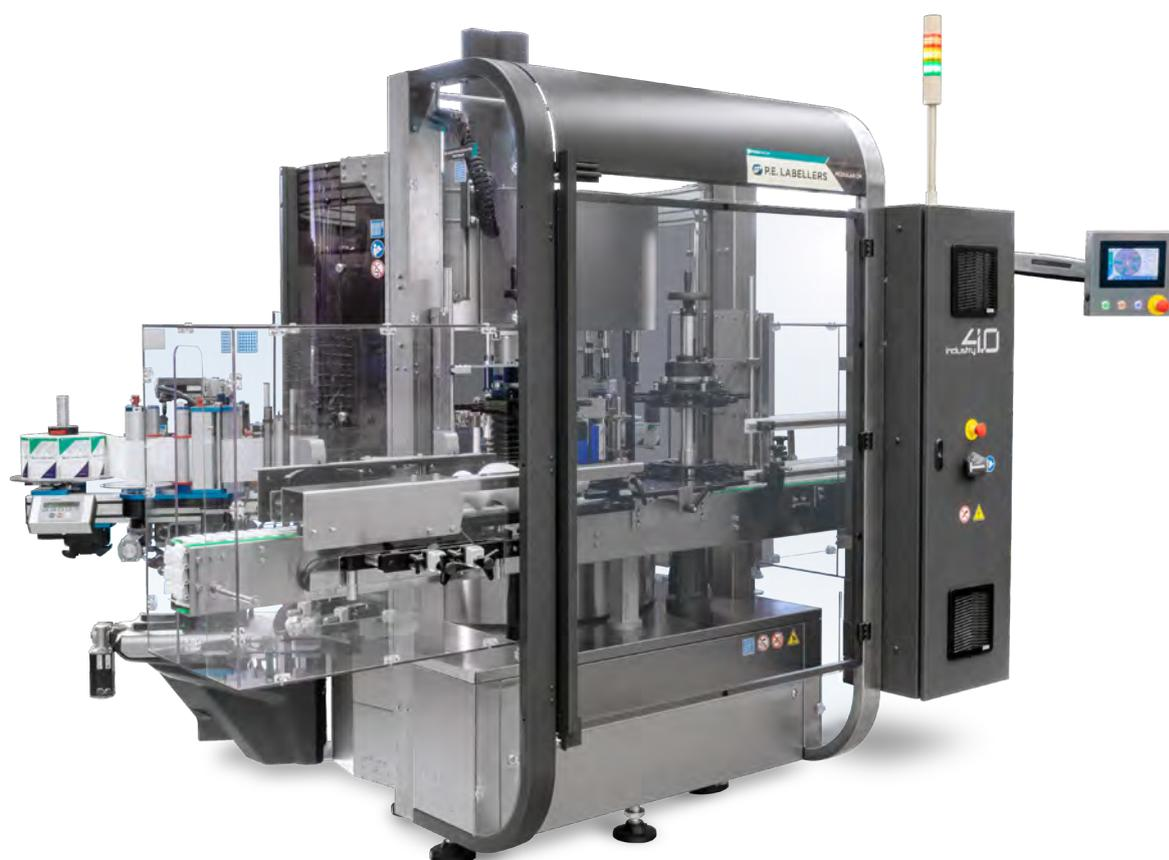
**M**ODULAR CM è la nuova macchina etichettatrice rotativa completamente ergonomica e modulare, dal layout riconfigurabile in maniera facile e veloce.
