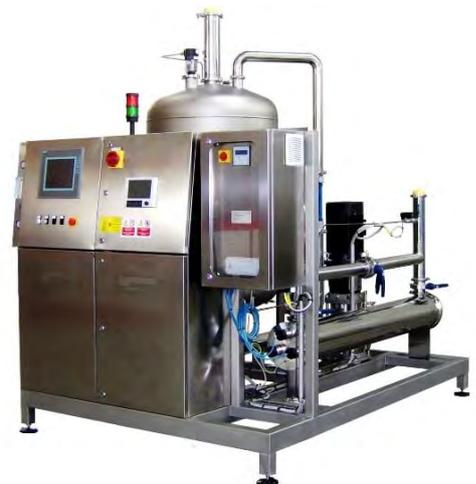
*Figura 2 Impianto di produzione ozono disciolto in acqua*
