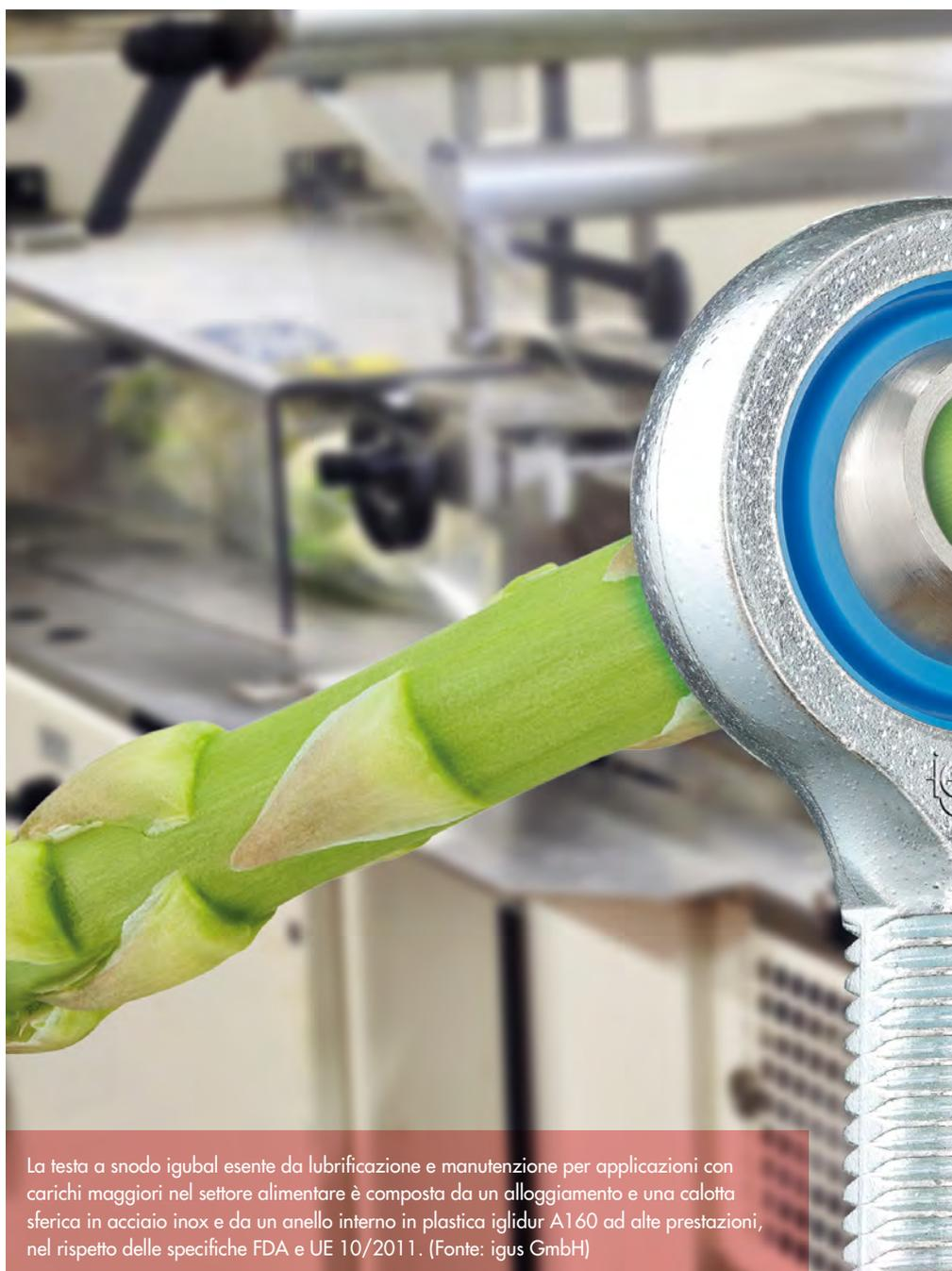
La testa a snodo igubal esente da lubrificazione e manutenzione per applicazioni con carichi maggiori nel settore alimentare è composta da un alloggiamento e una calotta sferica in acciaio inox e da un anello interno in plastica iglidur A160 ad alte prestazioni, nel rispetto delle specifiche FDA e UE 10/2011. (Fonte: igus GmbH)
