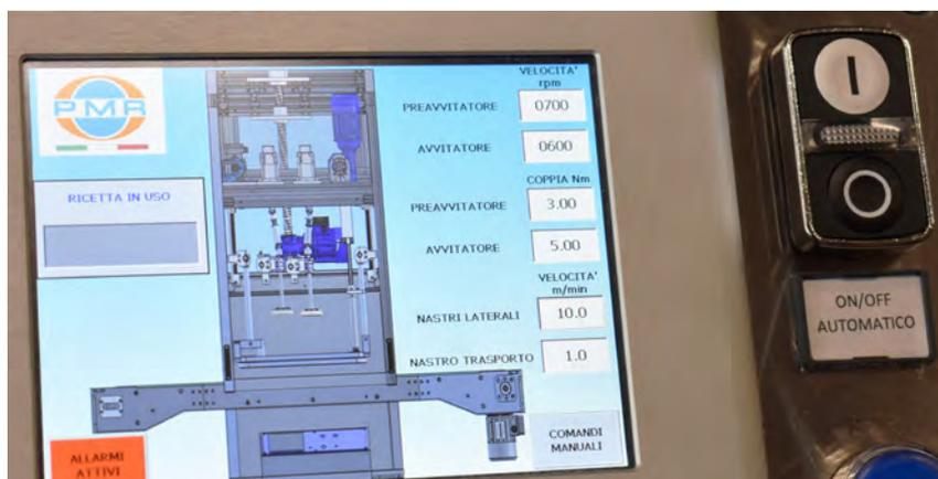
Nell'esposizione ci sarà anche il nuovo **Monoblocco PMR MFC 22**, una macchina per il riempimento di vasetti con prodotti liquidi/densi e la tappatura con capsule twist-off. Il dosatore volumetrico rotativo è composto da una pompa in acciaio inox AISI 316 e un ugello salvagoccia con valvola pilotata a due vie, sincronizzata alla dosata. Il tappatore ha una testina con motore pneumatico, con regolazione della coppia di avvitamento.
