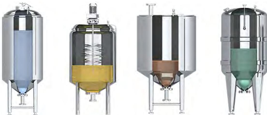
Il sensore di livello radar LW2720 è particolarmente indicato per applicazioni difficili, in presenza di sprayball, vapori e schizzi, liquidi viscosi ed in presenza di agitatori all'interno del tank
