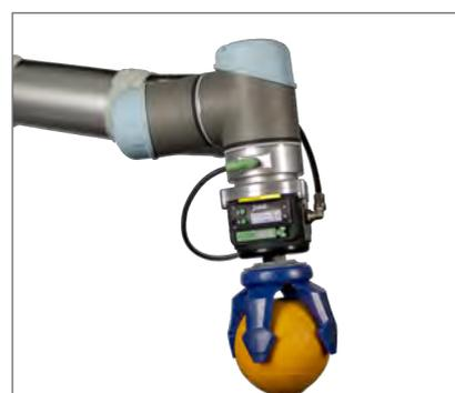
SOFTGRIP® sono facili da installare e controllare, come una ventosa. Non richiedono alcuna programmazione specifica. Per garantire la giusta forza di presa per una manipolazione delicata e sicura di oggetti delicati, il livello di vuoto può essere facilmente regolato.
