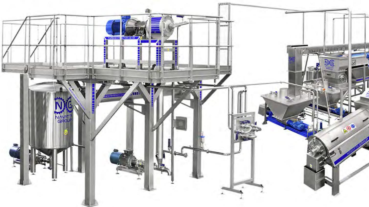
Linea di lavorazione integrata di frutta sia tropicale che mediterranea: lavaggio, filtrazione dell'acqua di lavaggio, cernita manuale, spazzolatura, preriscaldamento e spazzolatura del mango, triturazione della frutta, estrazione della purea. Lavaggio continuo dell'impianto.
