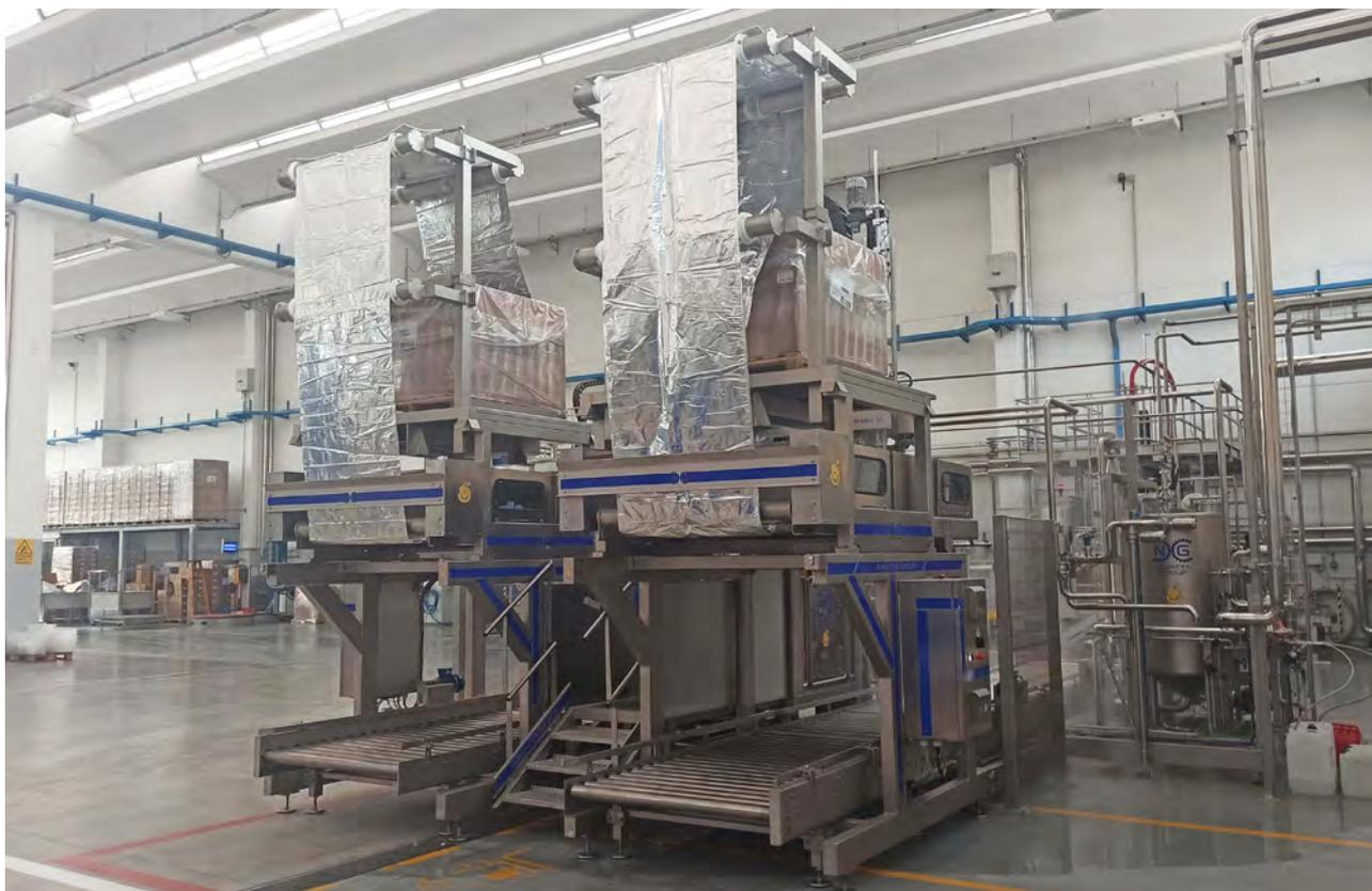
*Riempitrice aseptica a doppia testa per sacchi in fusti palettizzati da 220 litri e sacchi da 3-5-10-20 litri con sistema di alimentazione e riempimento automatico dei sacchi con il prodotto – nessuna esigenza di operatore – SISTEMA BREVETTATO – ELEVATA VELOCITA' DI RIEMPIMENTO.*
