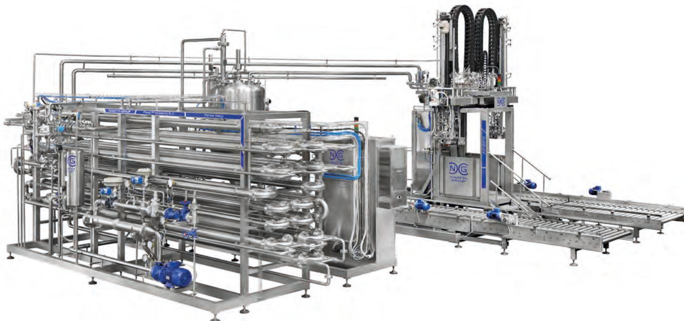
Sterilizzatore aseptico completo di riempitrice aseptica a doppia testa mod. AF2PD per fusti palettizzati da 220 litri e Bin-in-Box o IBCs da 1000-1500 l
