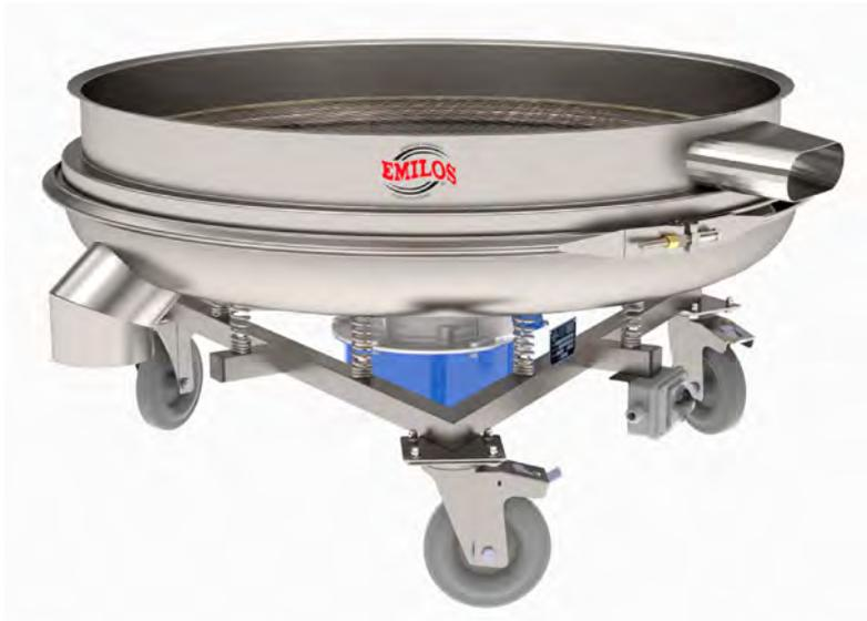
In caso di setacciatura di prodotti particolarmente difficili, Emilos, per eliminare le otturazioni delle maglie, aumentare la produzione, e ridurre i tempi morti causati dall'interruzione per pulire le maglie intasate, installa sui propri vibrovagli sistemi di disintasamento della rete: spazzole, vassoi forati corredati di sfere in gomma o anelli disintasanti, e telai portate dotati di razze e piccolo motore pneumatico temporizzato.
