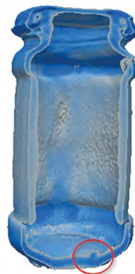
A sinistra le immagini a raggi X di un vasetto contaminato come acquisite da un sistema a quattro viste, in queste immagini il contaminante è praticamente invisibile e non rilevabile. A destra la sezione del render della ricostruzione tomografica ottenuta con Mito dello stesso vasetto in cui è evidenziato come l'inquinante sia facilmente rilevabile.
