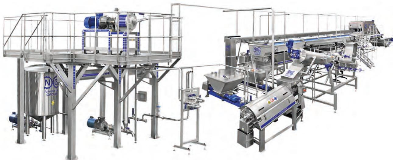
Linea di lavorazione integrata di frutta sia tropicale che mediterranea: lavaggio, filtrazione dell'acqua di lavaggio, cernita manuale, spazzolatura, preriscaldamento e spazzolatura del mango, triturazione della frutta, estrazione della purea. Lavaggio continuo dell'impianto.
