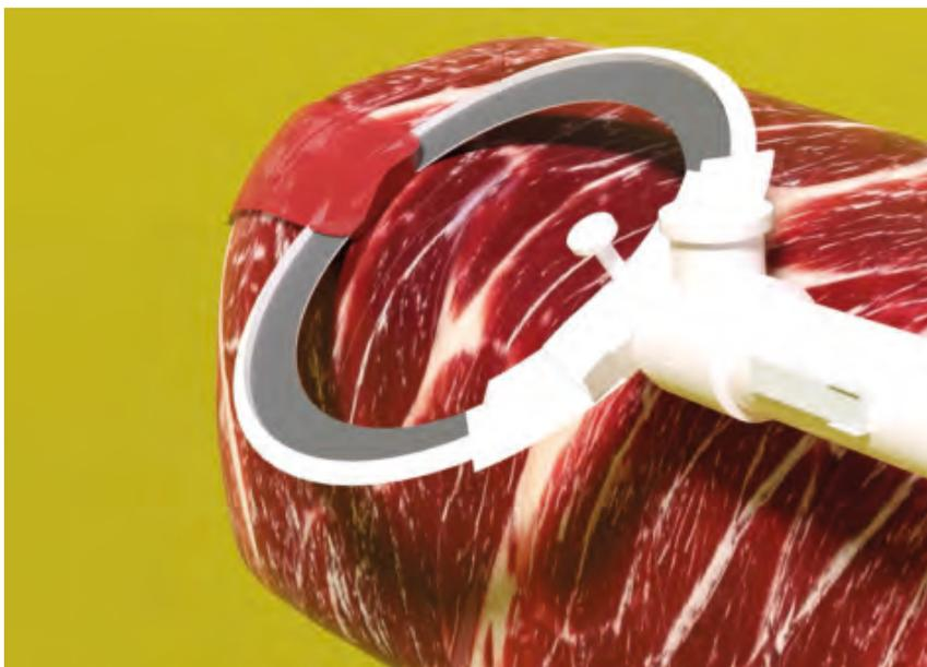
ingombranti, la compattezza e i pesi contenuti dei motori pneumatici comportano infatti **ingombri inferiori, pari ad un quarto di un motore elettrico** di potenza equivalente, e favoriscono la loro **installazione su qualsiasi utensile, anche il più piccolo**. Senza dimenticare il basso livello di vibrazioni trasmesse dal motore all'utensile e quindi al sistema mano-braccio.
