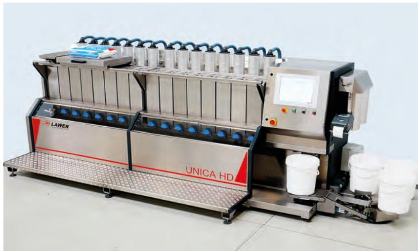
UNICA HD è dotata di silos in acciaio inox con una capacità di 50 l, e può essere configurata con 8-16 o 24 silos.
