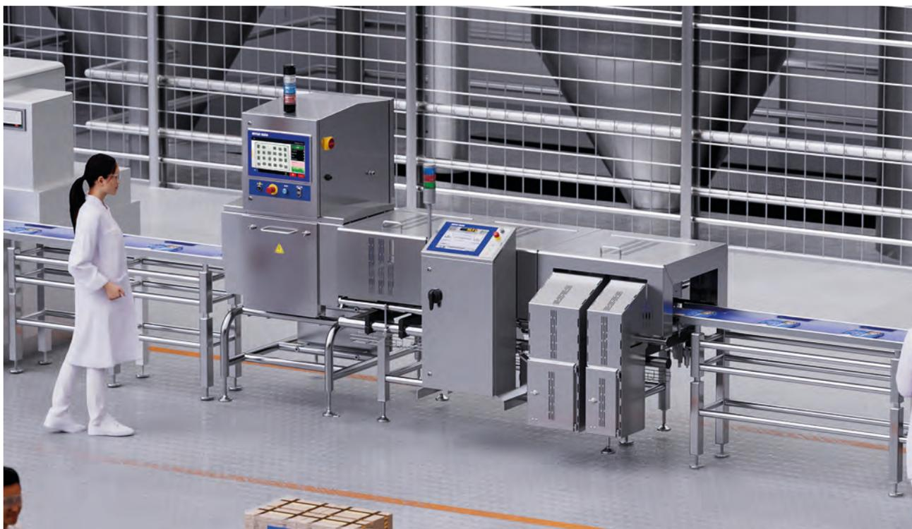
La Divisione Ispezione Prodotti di Mettler-Toledo, leader globale nella produzione di strumenti di precisione e tecnologie per l'ispezione prodotti, ha ampliato il proprio portfolio di soluzioni di ispezione combinate con il lancio dei nuovi sistemi combinati CM (controllo peso e rilevazione di metalli) e CX (controllo peso e ispezione a raggi-X).
