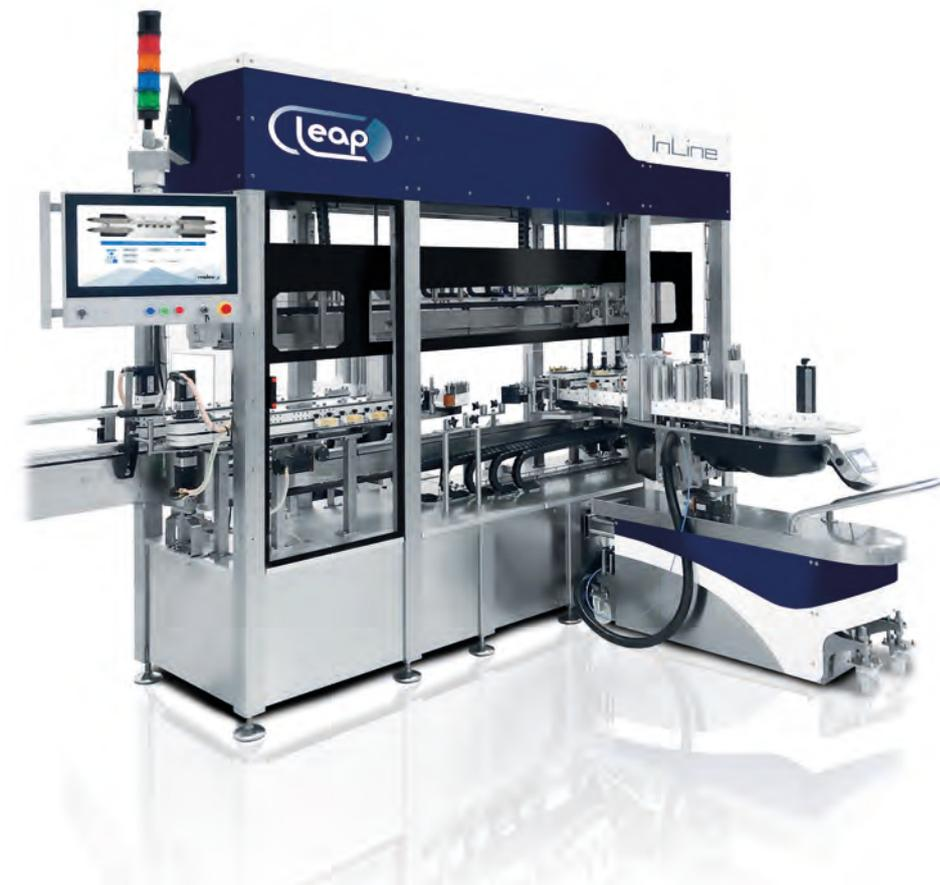
la macchina consente di sostituire o aggiungere all'unità Roll-Fed stazioni di incollaggio a freddo, autoadesive o hot-melt.
