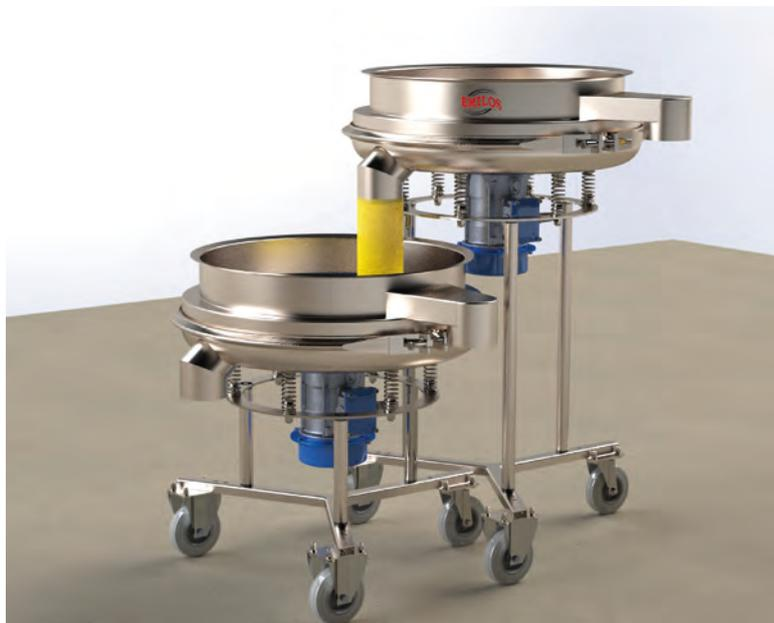
In caso di setacciatura di prodotti particolarmente difficili, Emilos, per eliminare le otturazioni delle maglie, aumentare la produzione, e ridurre i tempi morti causati dall'interruzione per pulire le maglie intasate, installa sui propri vibrovagli sistemi di disintasamento della rete: spazzole, vassoi forati corredati di sfere in gomma o anelli disintasanti, e telai portate dotati di razze e piccolo motore pneumatico temporizzato.
